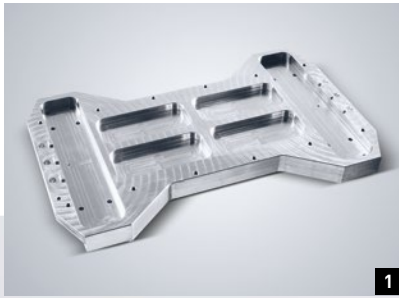
1. Стыковочная пластина Материал: алюминий Размеры: 325 × 200 × 23 мм Время обработки: 30 мин.
