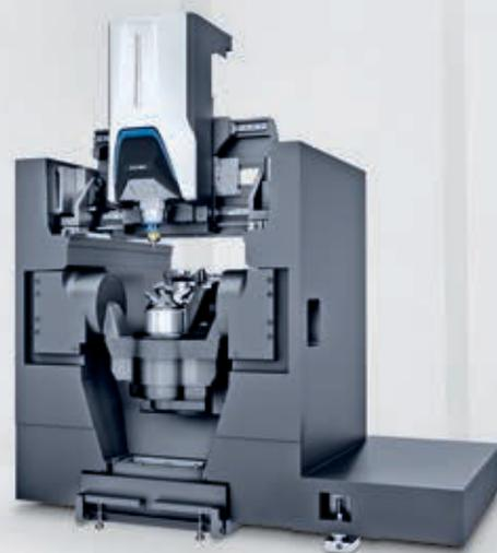
Жесткая, очень компактная, станина из минерального литья, эффективно гасящая вибрации, обеспечивает стабильность обработки в течение длительного времени, точность изготовления и оптимальный сброс стружки (Y-образная конструкция в портальном исполнении).
