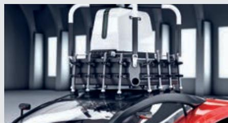
Подгонка крыши автомобиля из углепластика
