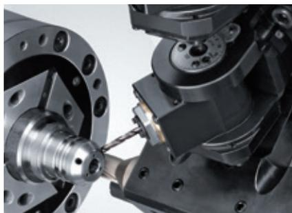
Обработка наклонных отверстий с помощью универсального держателя
