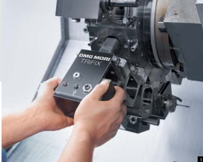
1+2: Инструменты с креплением TRIFIX® обеспечивают высокую стабильность и точность повторений 6 мкм 3: 12-позиционная револьверная головка с креплением TRIFIX® обеспечивает точность позиционирования < 10 мкм
