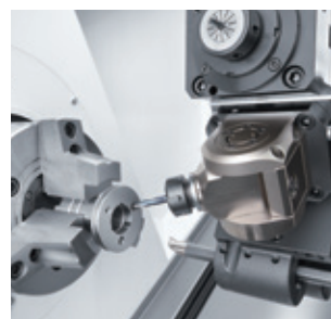
Обработка наклонных отверстий с помощью универсального держателя
