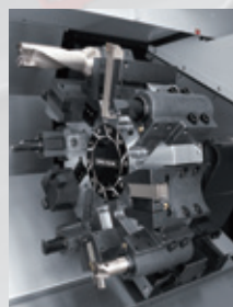
Исполнение для 2-осевой токарной обработки 10-позиционная револьверная голова
