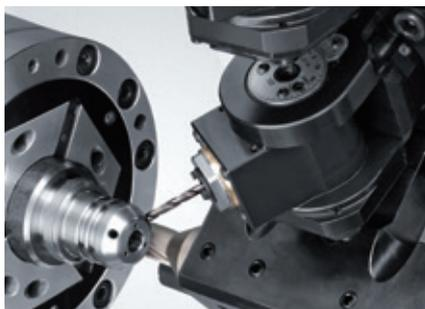
Обработка наклонных отверстий с помощью универсального держателя
